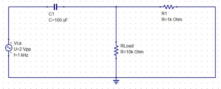
6- Medir a tensão RMS sobre o resistor Rload (Vca) com o osciloscópio. Calcular a corrente:
