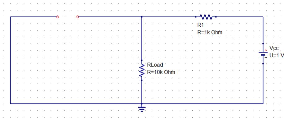
7- Medir a tensão e a corrente sobre o resistor Rload com o multímetro.
